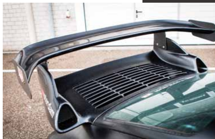
De hele kit, inclusief deze machtige GT2-look vleugel, is van glasweefsel gemaakt en oersterk
