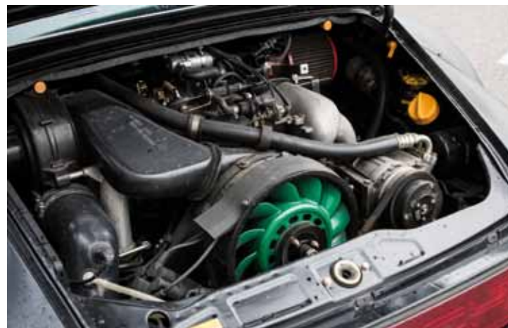
De onverwoestbare zescilinder boxermotor, met wat kleine aanpassingen goed voor 300 pk
