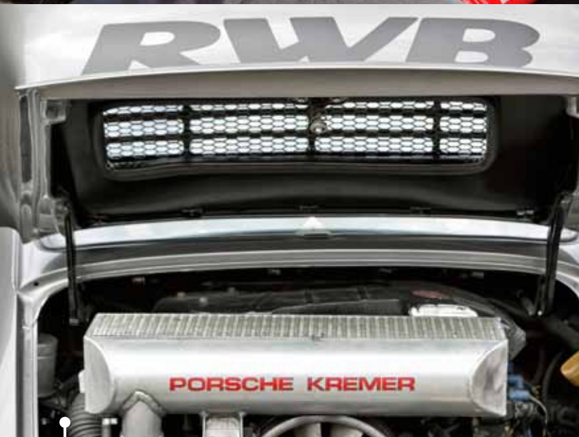
Peperdure Kremer-intercooler. De wielen zijn van het Amerikaanse Works en hebben de maat 10,5 j x 18 voor en 12,5 j x 18 achter. Voor staat hij op 265/35 R18-banden, achter op 315/30 R18.
